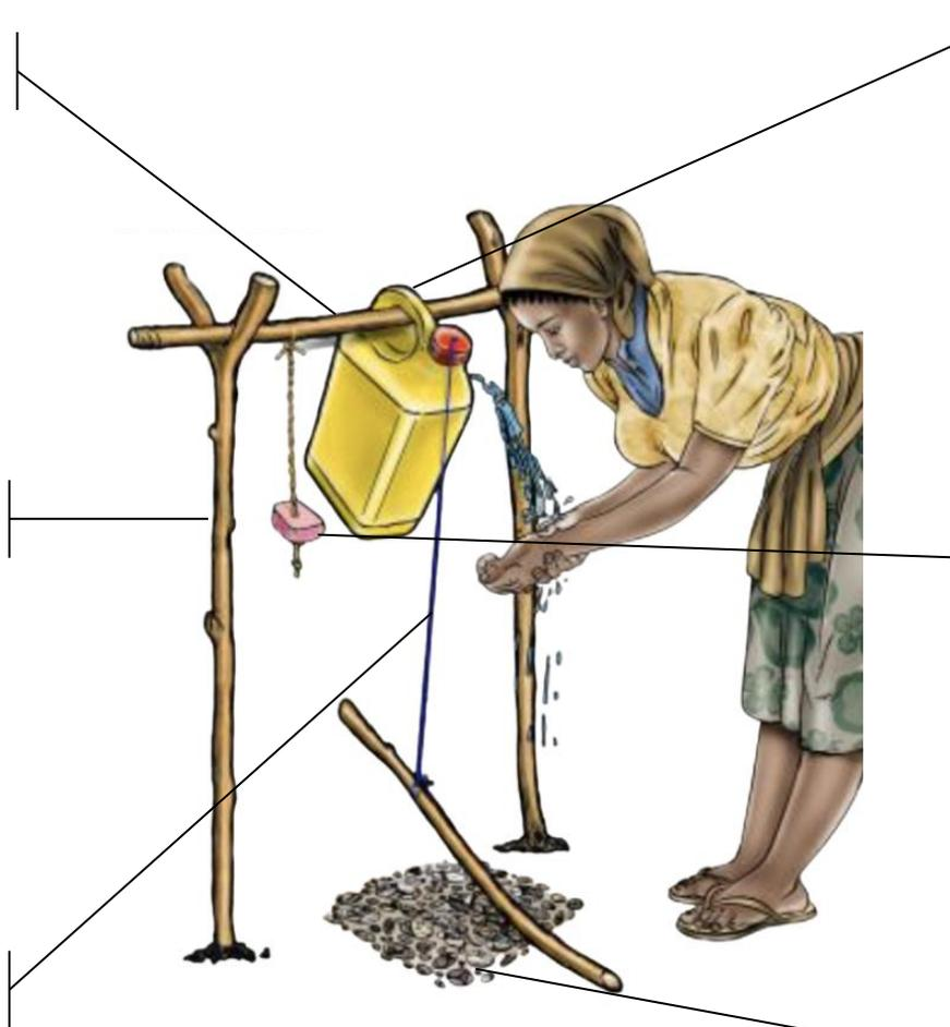
Bidon ou bouteille (1 à 5 litres), souvent recyclé, servant de réserve d'eau. Sa taille détermine le nombre d'utilisations possibles avant remplissage
