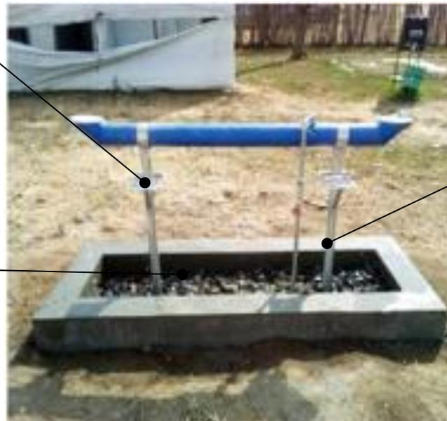
Châssis circulaire ou rectangulaire en métal ou plastique renforcé. Doit être stable et résistant, même une fois le réservoir plein.
