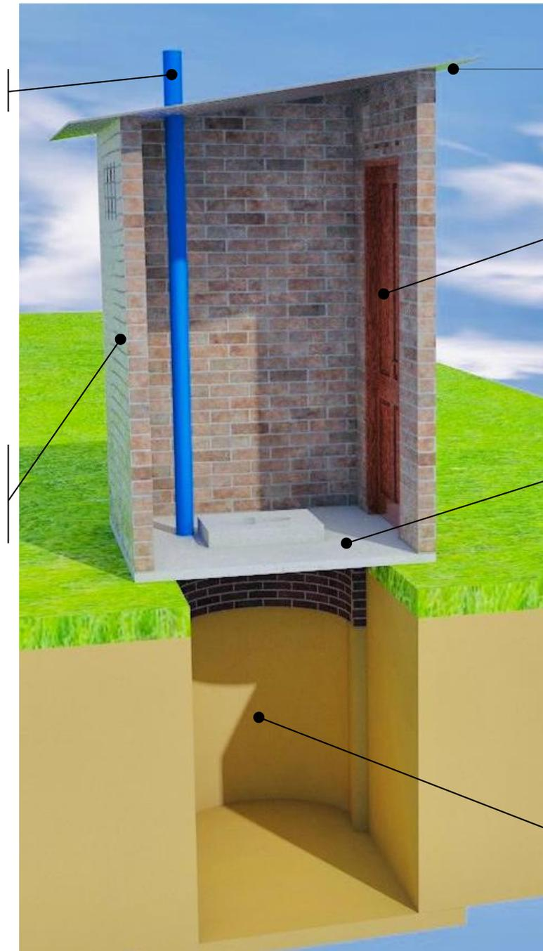
Toiture en tôle ou autres matériaux sur charpente en bois.
