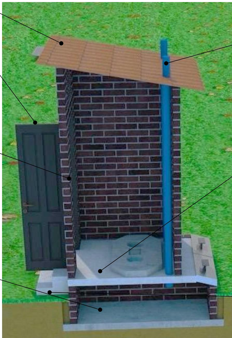
2 conduites en PVC de 75 cm de diamètre avec grille anti-mouche pour permettre la ventilation du contenu des 2 fosses
