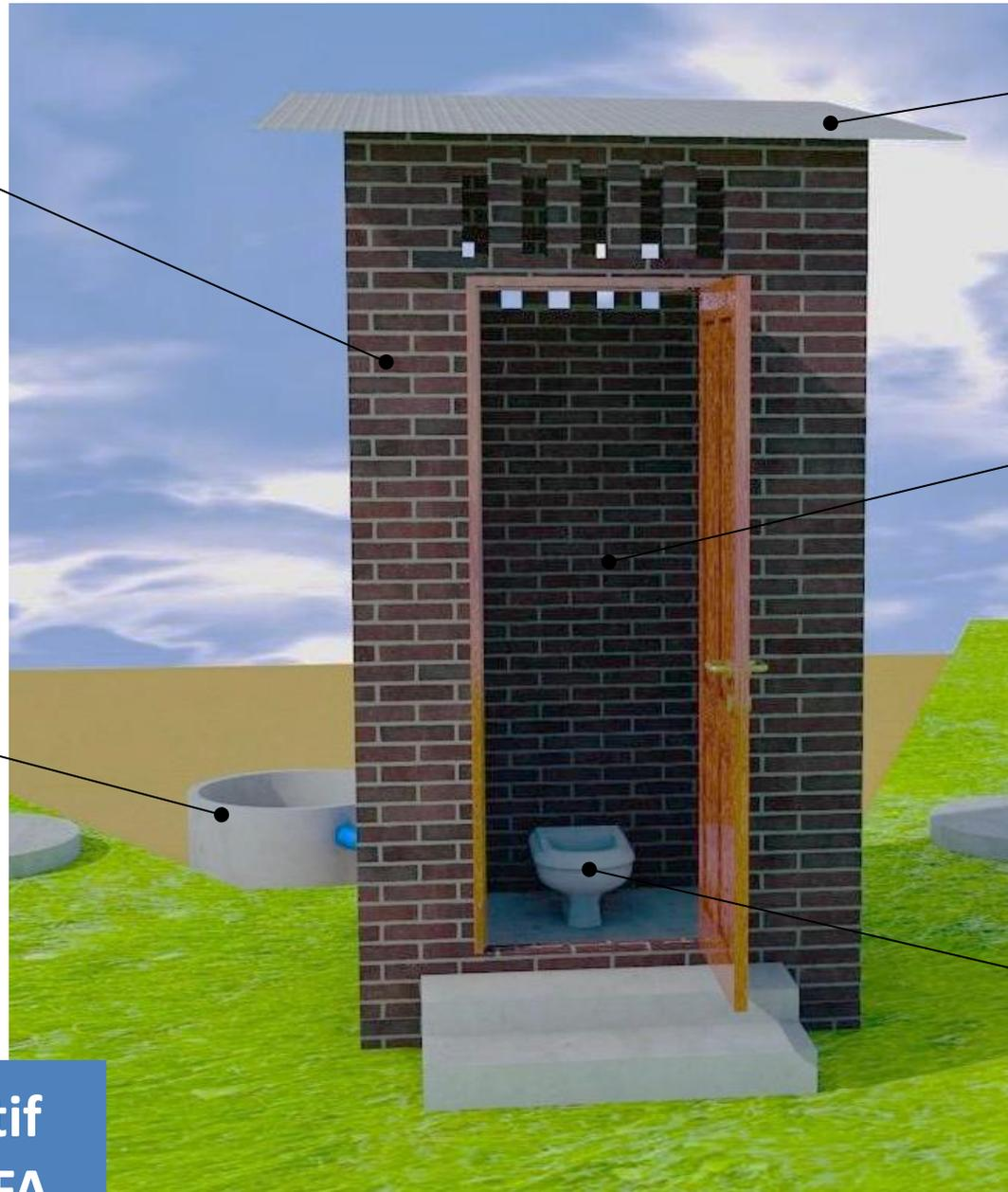
Toiture en tôle ou autres matériaux sur charpente en bois.
