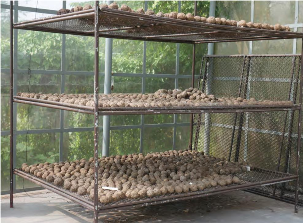
Briquetas em bandejas de secado KCC
