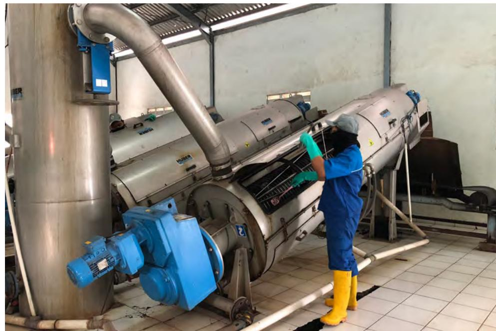
Uma prensa de parafuso Huber em funcionamento
