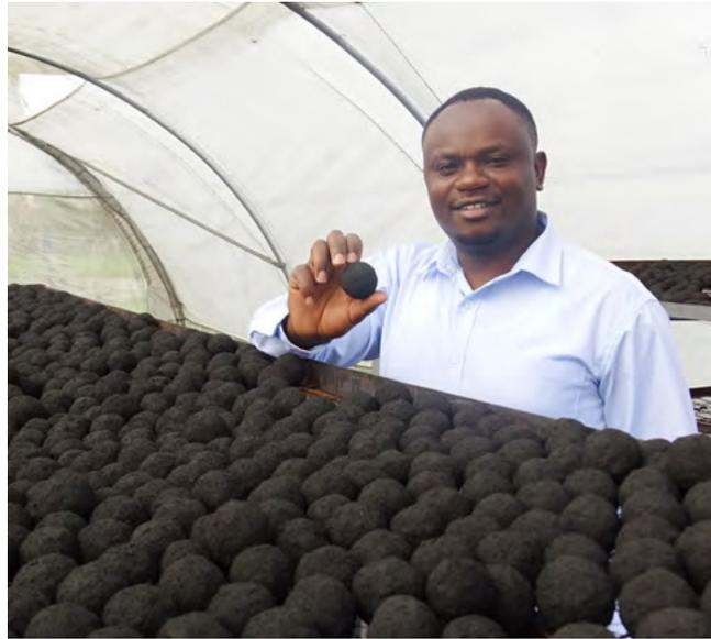
Briquetes carbonizados de forma redonda em leitos de secagem
