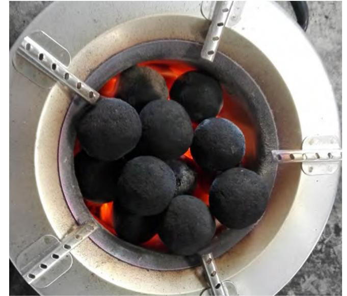
Briquetas carbonizadas de forma redonda utilizadas como fuente de combustible alternativa
