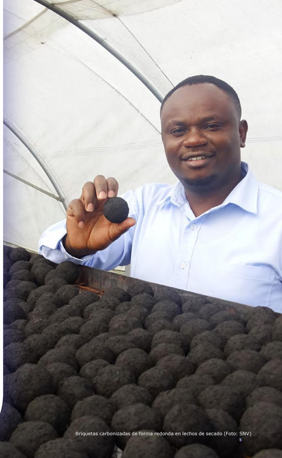
Briquetas carbonizadas de forma redonda en lechos de secado (Foto: SNV)
