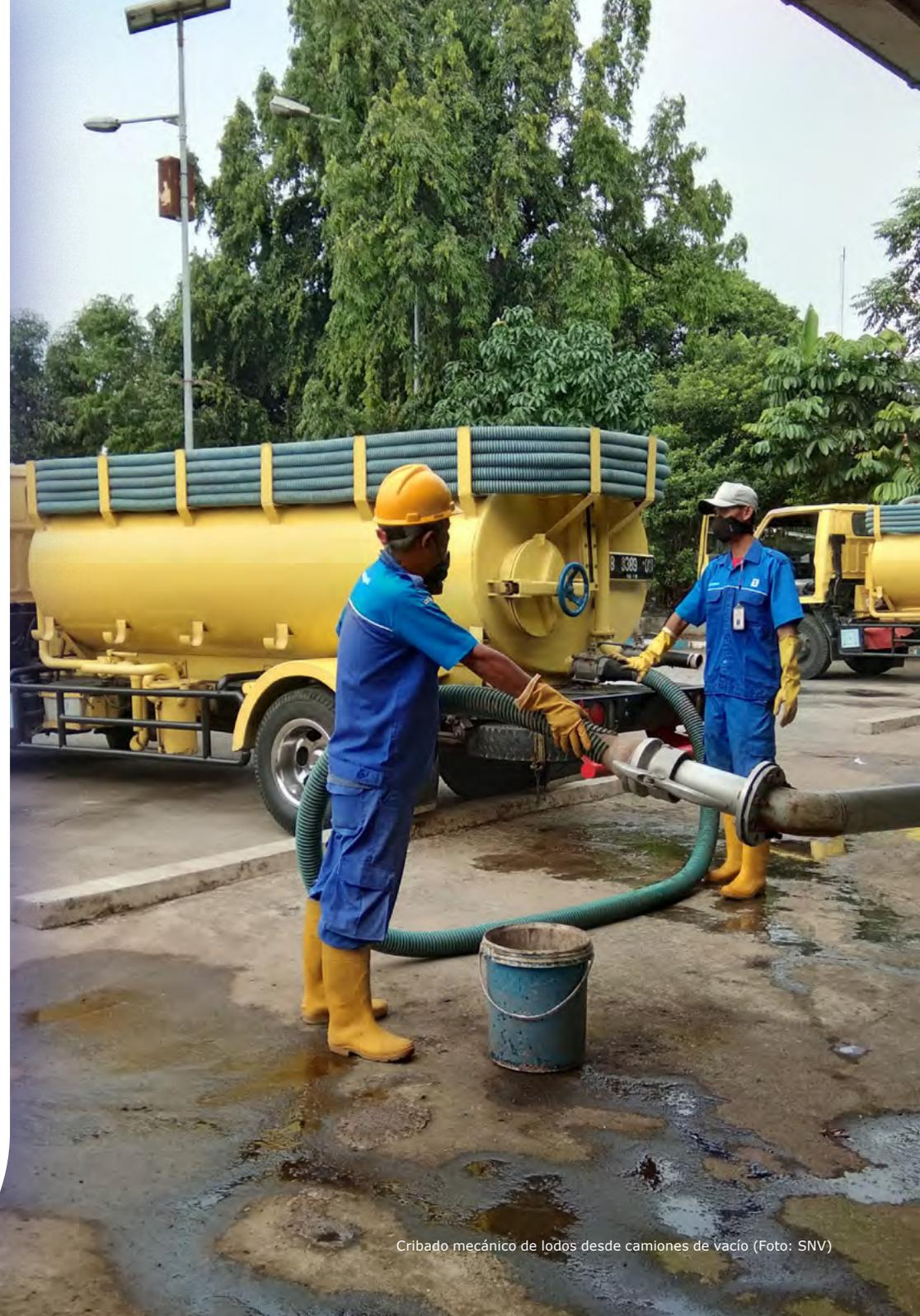
Cribado mecánico de lodos desde camiones de vacío (Foto: SNV)
