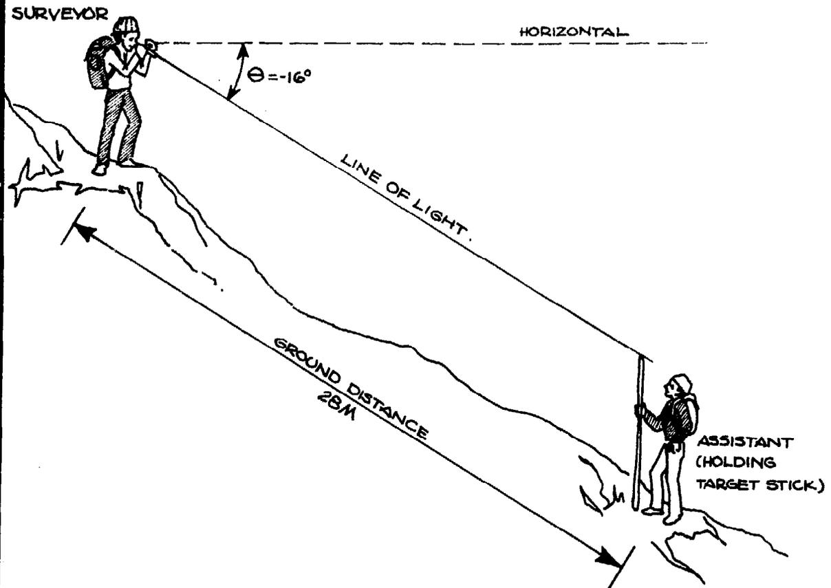
FIGURE 3-5 TRIGONOMETRIC SURVEYING WITH AN ABNEY LEVEL
