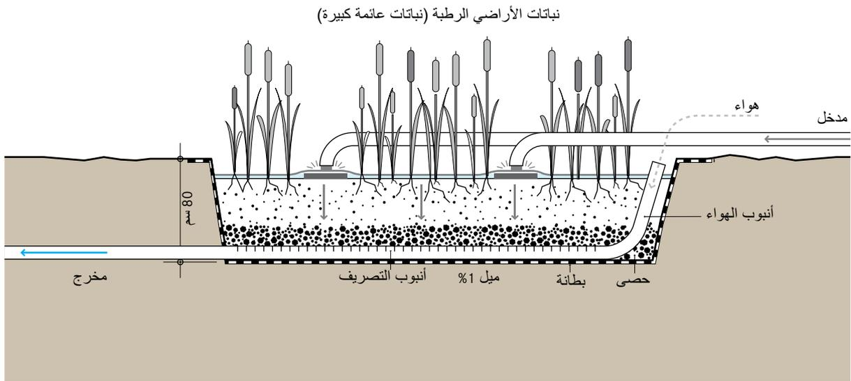
النباتي هو الحفاظ على النفاذية في الوسط الترشيحي، وتوفير بيئة صالحة لنمو الكائنات الحية الدقيقة. يتم امتصاص وتحلل المغذيات والمواد العضوية بواسطة تجمعات من الكائنات الحية الدقيقة. بإجبار الكائنات الحية الدقيقة على الدخول في طور جوع شديد بين المراحل التي يتم فيها حقن الجُرعَات؛ فإن النمو المفرط للكتلة الحيوية يمكن أن ينخفض وبذلك تزيد المسامية.
