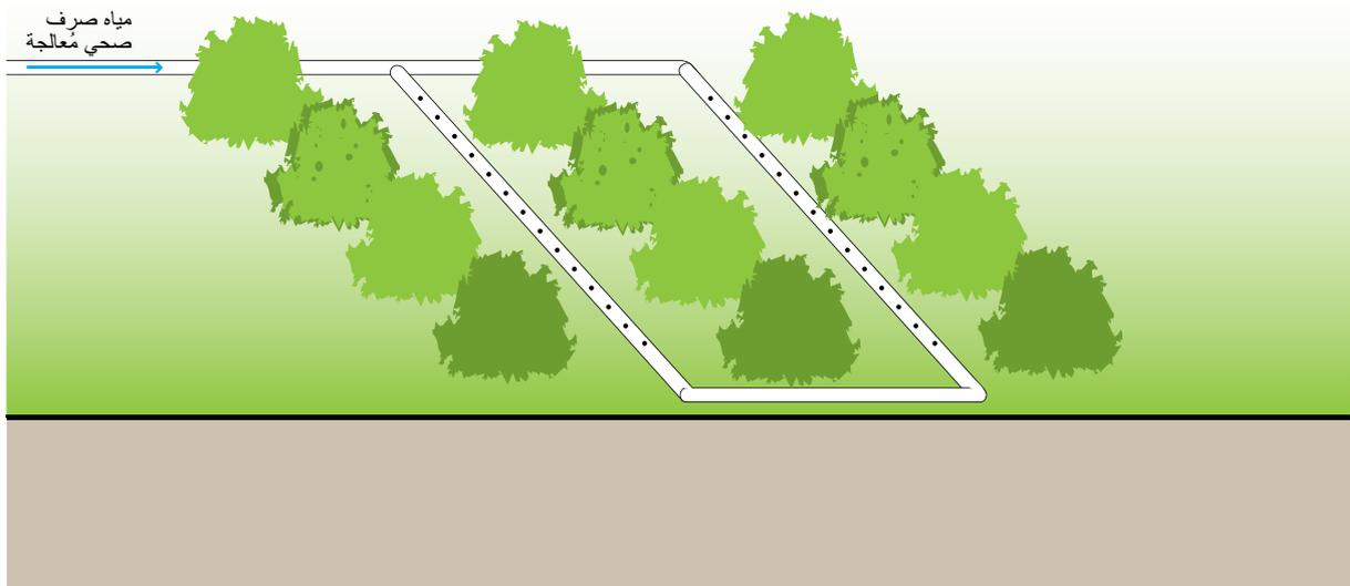
اعتبارات التصميم يجب أن يكون معدل استخدام مياه الصرف الصحي المُعالجة للري مناسباً للتربة والمحاصيل والمناخ، وإلا يصبح الاستخدام مضرًا. ولزيادة قيمة العناصر المغذية في مياه الري؛ فإنه من الممكن أن يُخلط (يُحقن) البول مع مياه الري، وهذا ما يسمى "التسميد في الري (أو الري المُسمَد) Fertigation" (أي التسميد + الري). و يجب أن تتناسب نسبة تخفيف البول في المياه مع الاحتياجات الخاصة للمحصول ومقاومته.
