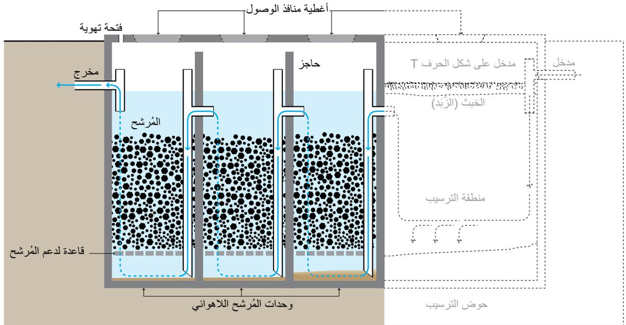
يتم تشغيل المُرَشِّحات اللاهوائية عادة بنظام التدفق إلى الأعلى (العلوي)؛ لتجنب خطر نزح الكتلة الحيوية الثابتة للخارج. ويجب أن يرتفع منسوب المياه فوق المُرَشِّح بحوالي 0.3 متر على الأقل لضمان تدفق متجانس. ويُعتبر زمن البقاء الهيدروليكي Hydraulic Retention Time (HRT) هو أهم محددات التصميم تأثيراً على أداء المُرَشِّح، ويوصى بأن يكون من 12 إلى 36 ساعة.
