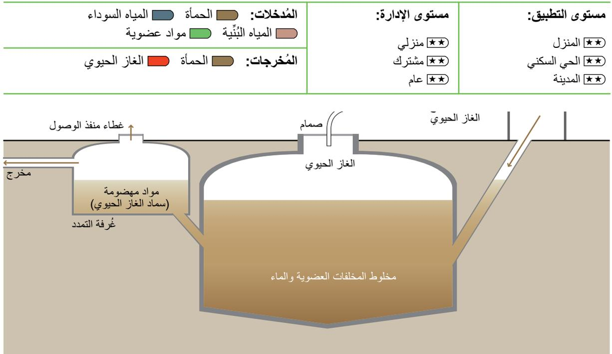
التمدد، ثم يسقط المخلوط مرة أخرى داخل المفاعل عند خروج الغاز، ويتم استخدام الضغط المتولد لنقل الغاز الحيوي عبر الأنابيب. أما في حالة المفاعل ذي القبة الطافية فإن القبة ترتفع وتنخفض مع إنتاج الغاز وخروجه، أو من الممكن استخدام بدائل يمكنها أن تتمدد (مثل البالون). وللمحد من الهدر الناتج عن التوزيع فإنه يجب إنشاء المفاعل بالقرب من نقاط استخدام الغاز.
