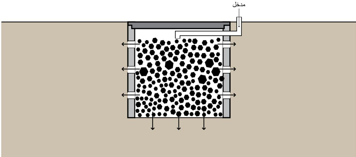
خُفْرَة الامتصاص (أو خُفْرَة التصريف، أو خُفْرَة التشرب، أو بئر الترسيب) هي عبارة عن غرفة مغطاة، مسامية الجدران، وتسمح للمياه أن تتسرب ببطء إلى طبقات التربة. التدفقات السائلة الخارجة (المُعالجة) التي تم ترسيب محتوياتها مبدئيًا في إحدى تقنيات الجمع والتخزين/المُعالجة أو المُعالجة (شبه) المركزية، يتم تصريفها إلى غرفة تحت الأرض حيث يتم ارتشاحها إلى التربة المحيطة.
