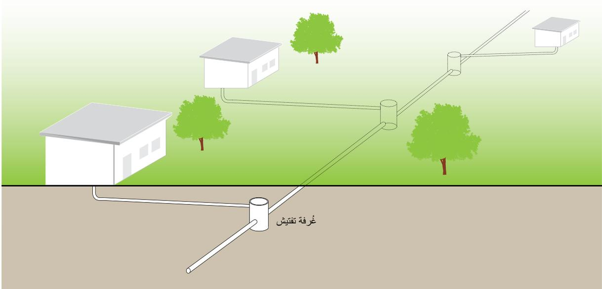
اعتبارات التصميم على النقيض من شبكات الصرف الصحي التقليدية التي صُممت لضمان الحد الأدنى لسرعة جريان المياه للتنظيف الذاتي، فإن تصميم شبكة الصرف الصحي البسيطة مبني على الحد الأدنى لجهد الإزالة Tractive Tension، ويساوي 1 نيوتن/م<sup>2</sup> (1 باسكال) في حالة أعلى تدفق للمياه (تدفق الذروة) Peak Flow داخل الشبكة. ويجب ألا يقل أعلى تدفق للمياه عن 1.5 لتر/ثانية، وأقل قطر مطلوب لأنبوب الشبكة هو 100 ملليمتر.
