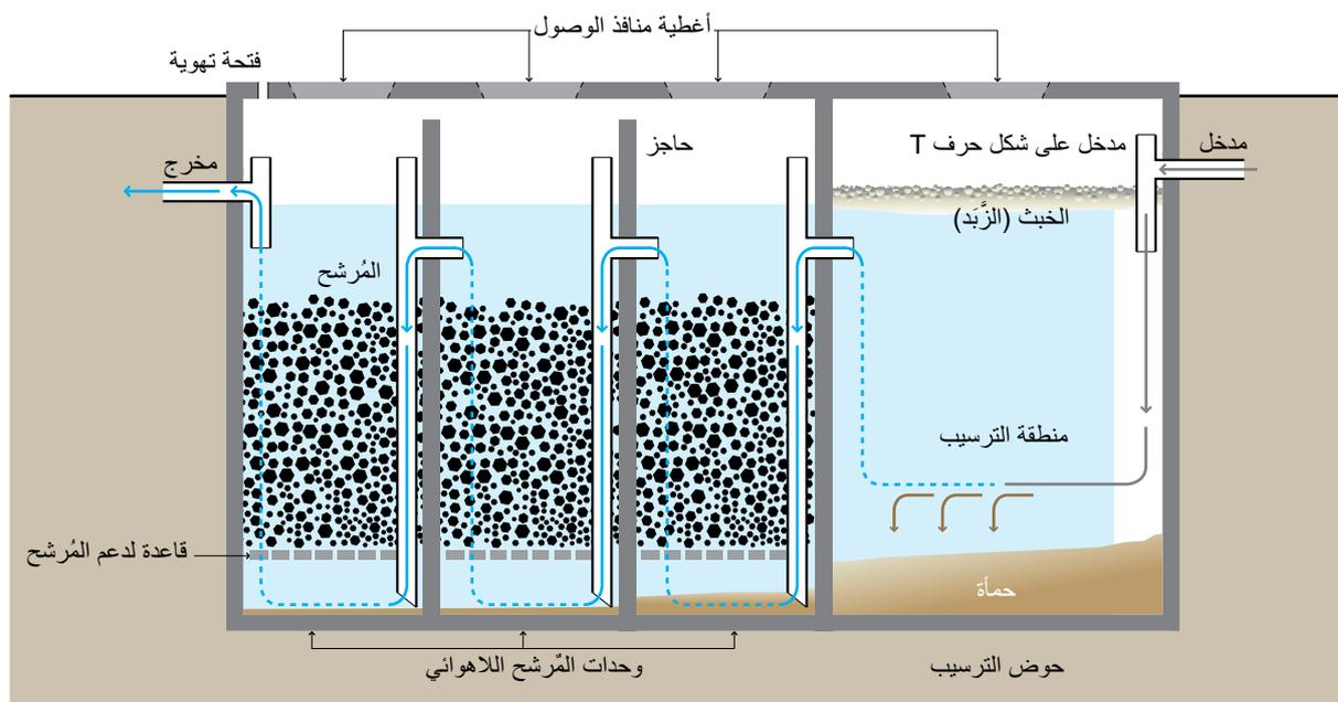
يتم تشغيل المُرشحات اللاهوائية عادة بنظام التدفق إلى الأعلى (العلوي)؛ لتجنب خطر نزح الكتلة الحيوية الثابتة للخارج. ويجب أن يرتفع منسوب المياه فوق المُرشح بحوالي 0.3 متر على الأقل لضمان تدفق متجانس. ويُعتبر زمن البقاء الهيدروليكي Hydraulic Retention Time (HRT) هو أهم محددات التصميم تأثيرًا على أداء المُرشح، ويوصى بزمن بقاء هيدروليكي للمياه من 12 إلى 36 ساعة.
