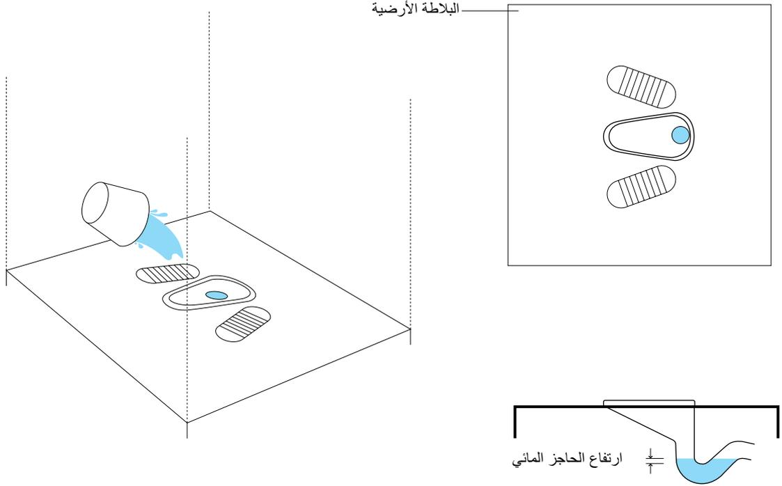
المائية من البلاستيك أو السيراميك؛ لمنع الانسدادات، ولتسهيل من عملية التنظيف (فالخرسانة قد تسبب الانسدادات بسهولة إذا كانت خشنة الملمس).
