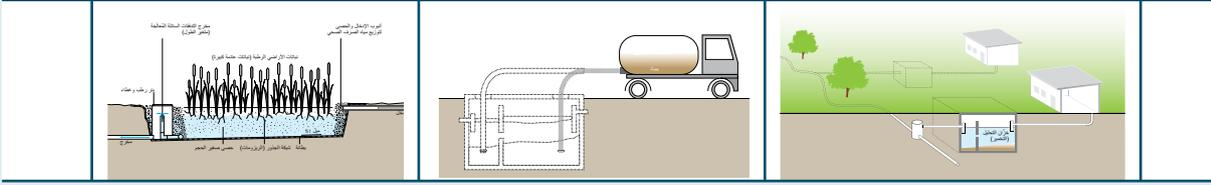
الاعتبارات يتناسب هذا النظام بصفة خاصة مع المناطق الحضرية حيث تكون التربة غير مناسبة لارتشاح التدفقات السائلة الخارجة، ولأن شبكة الصرف الصحي في الحالة المثالية- تكون معزولة (غير منفذة للمياه)، فإن هذا النظام يكون قابل للتطبيق-أيضاً- في المناطق ذات مناسيب المياه الجوفية العالية. ويمكن استخدام هذا النظام كوسيلة لتحسين أداء تقنيات الجمع والتخزين/المعالجة القائمة بالفعل والتي تكون دون المستوى (على سبيل المثال، خزانات التحليل (التخمير) عن طريق تقديم معالجة مُحسَّنة.
