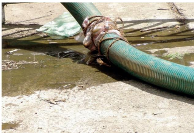
Figure 4.4 : Les tuyaux et accouplements doivent être régulièrement contrôlés et changés. Sur cette photographie, des boues fuient car la connexion n'est plus étanche (photo : David M. Robbins).
