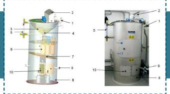
Filtersäcke aus Nylon haben eine Porengröße von 5 µm. Das MAP wird zurückgehalten und der Urin-Überstand tropft hindurch. Diese Flüssigkeit wird in der Kammer im unteren Reaktorteil gesammelt (siehe Abbildung 2) und müsste einer weiteren Behandlung zugeführt werden, da sie noch einen hohen Ammoniumgehalt hat (dieses Verfahren entfernt typischerweise nur 10% des im Urin enthaltenen Ammoniums).
