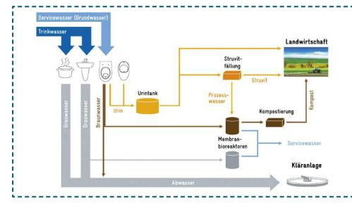
Übersicht über das angestrebte Abwassersystem für den Mittelteil des Haupthauses der GTZ in Eschborn (alle Komponenten außer der Braun- und Grauwasserbehandlung sind schon in Betrieb).
