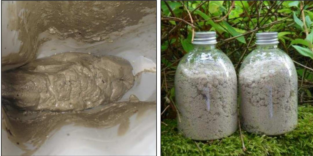
Abbildung 6: Links: Innenansicht eines eingesetzten Nylonfiltersacks nach vier Zyklen Befüllung nach der Entnahme aus dem Reaktor (Foto von Johanna Heynemann, 2010). Rechts: Getrocknetes MAP nach Abfüllung (Foto von Martina Winker, 2010).
