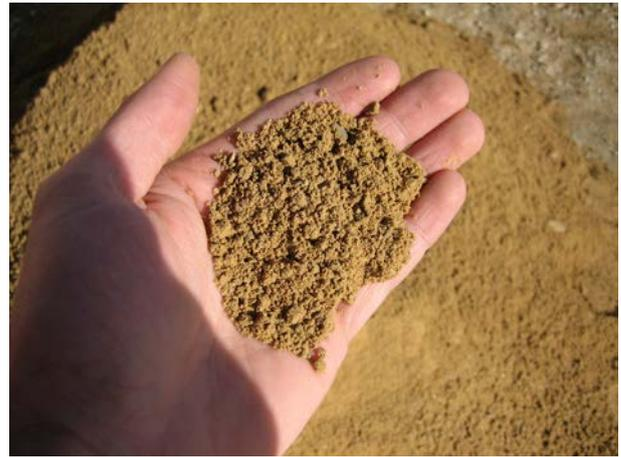
**Image 688** : Sable de mauvaise qualité (haute teneur d'argile).
