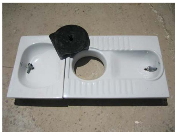
**Image 710** : Siège de toilette à séparation d'urine (type indien de Shital Ceramics). Le compartiment à gauche est prévu pour les eaux de nettoyage anal. Dimensions : 895 x 425 mm (pièce nettoyage anale : 310 x 425 mm, pièce toilette : 585 x 425 mm). [www.ruralsanitation.net](http://www.ruralsanitation.net)
