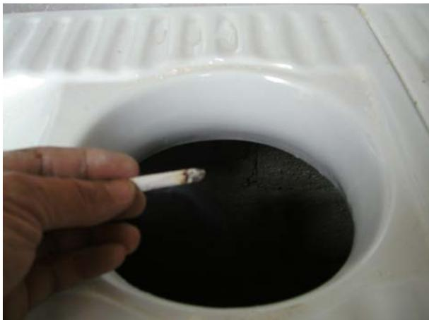
**Image 199** : Test de fonctionnement de la ventilation – la fumée descend dans la fosse et remonte par le tuyau de ventilation, ce qui prouve que le courant d'air fonctionne.
