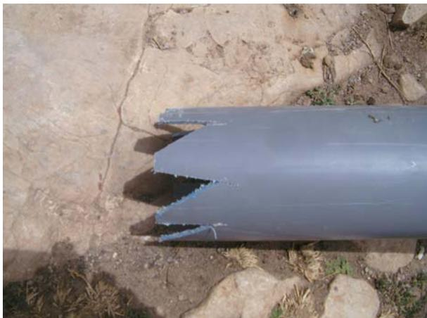
**Image 98** : Tuyau plongeur pour le réservoir d'urine.
