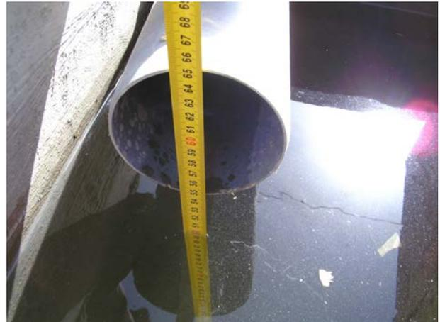
**Image 223 :** Le niveau de l'entrée est de 5 cm au-dessus du niveau d'eau.
