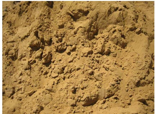
**Image 694** : Sable jaune, utilisé surtout pour les enduits du digesteur (?).
