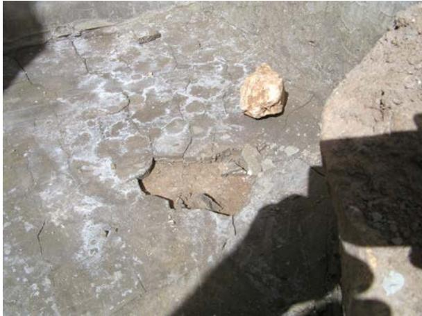
**Image 119 :** Fissures dans une mauvaise couche d'enduits sans sable et avec trop de SikaLite.
