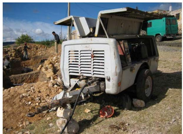
**Image 378** : Compresseur pour le marteau pneumatique.
