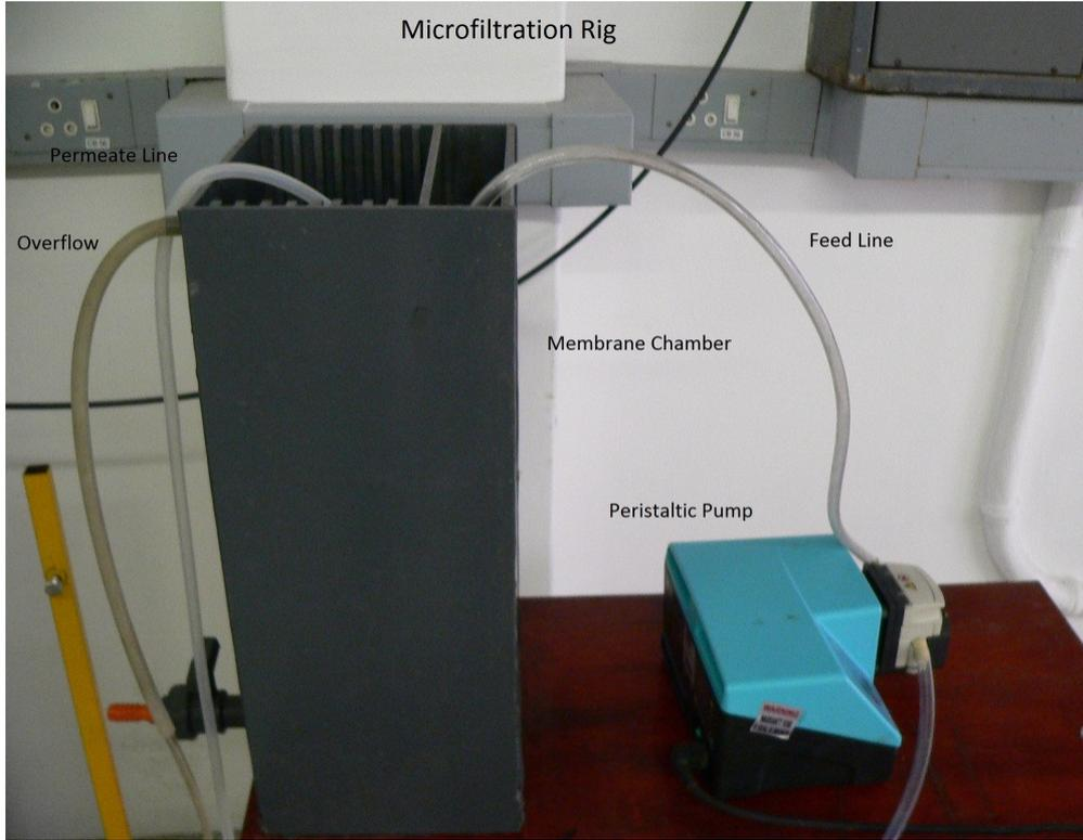
**FIGURE A7.3 MICROFILTRATION TEST RIG**
