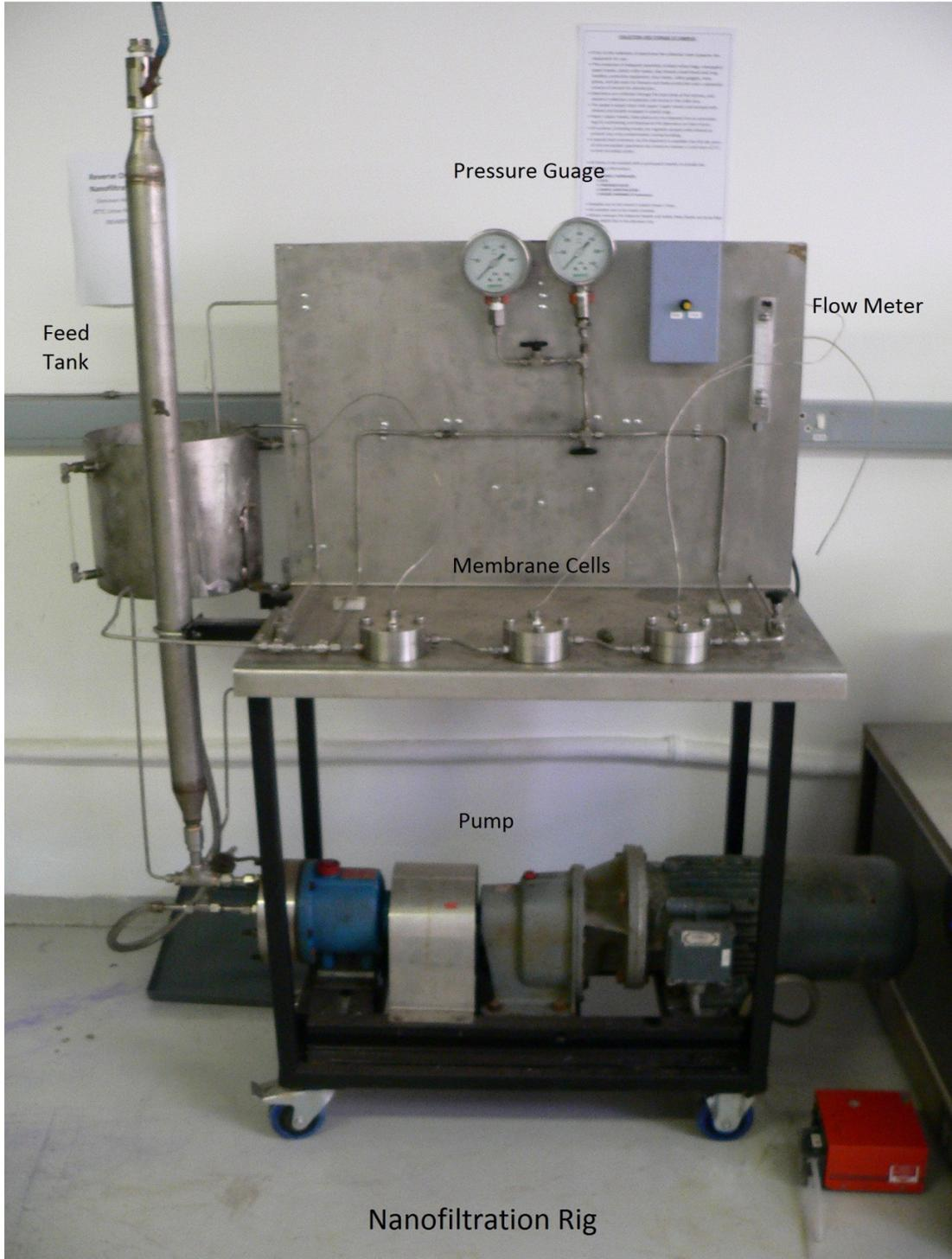
**FIGURE A7.6 NANOFILTRATION MEMBRANE RIG**
