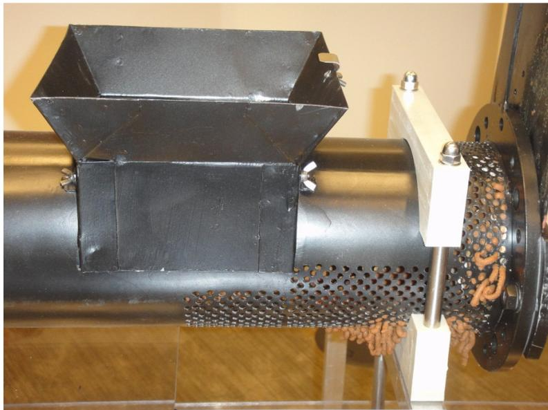
**FIGURE 5.4 EXTRUDER OPERATION: FAECAL SIMULANT EXTRUDED FROM RAM**
