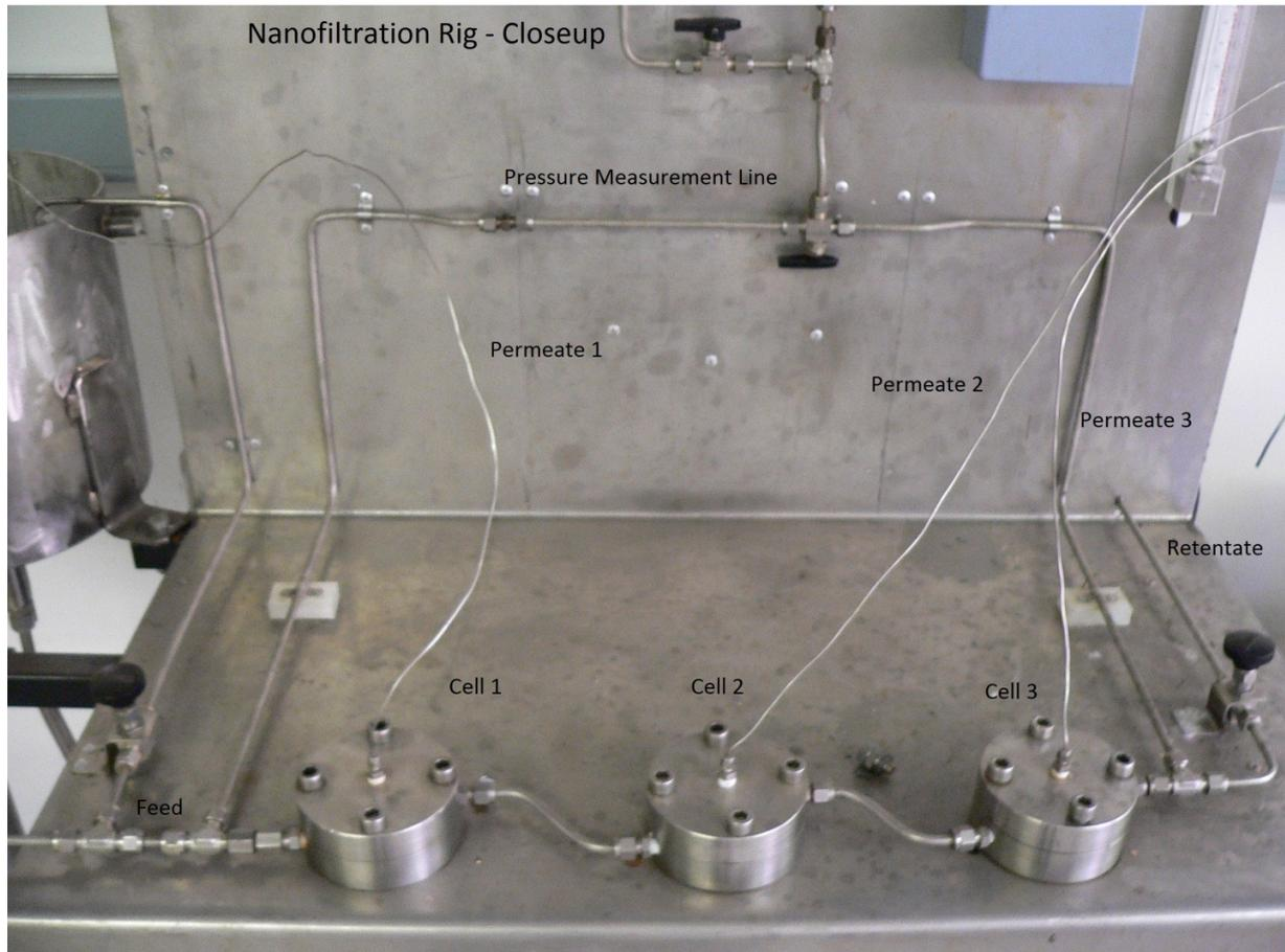
**FIGURE A7.7 NANOFILTRATION RIG MEMBRANE CELLS**
