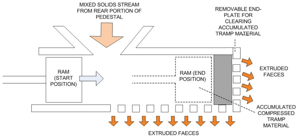
**FIGURE 5.3 CONCEPT FOR EXTRUSION-SEPARATION SYSTEM**
