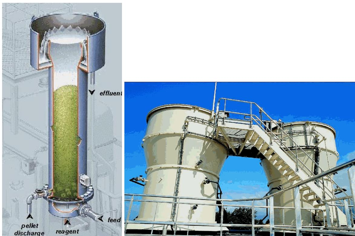
Figure 57 : Principe du Crystalactor® et aperçu des réacteurs à Geestmerambacht<sup>178</sup>
