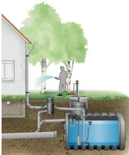
**Figure 8 : Installation de collecte de pluie<sup>28</sup>**
