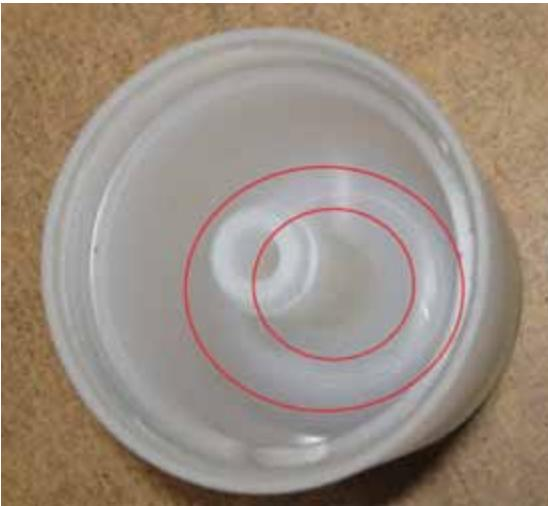
**Abbildung 5:** Neuer Urinablaufsiphon mit abgerundeten Innenkanten zur Reduktion der Möglichkeit von Ablagerungen in den weniger durchspülten Innenecken des Ventilkörpers
