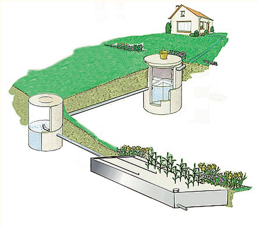
**Figure 1. Schematic sketch of the system components of a CW system „Type Ökologisches Projekt“**
