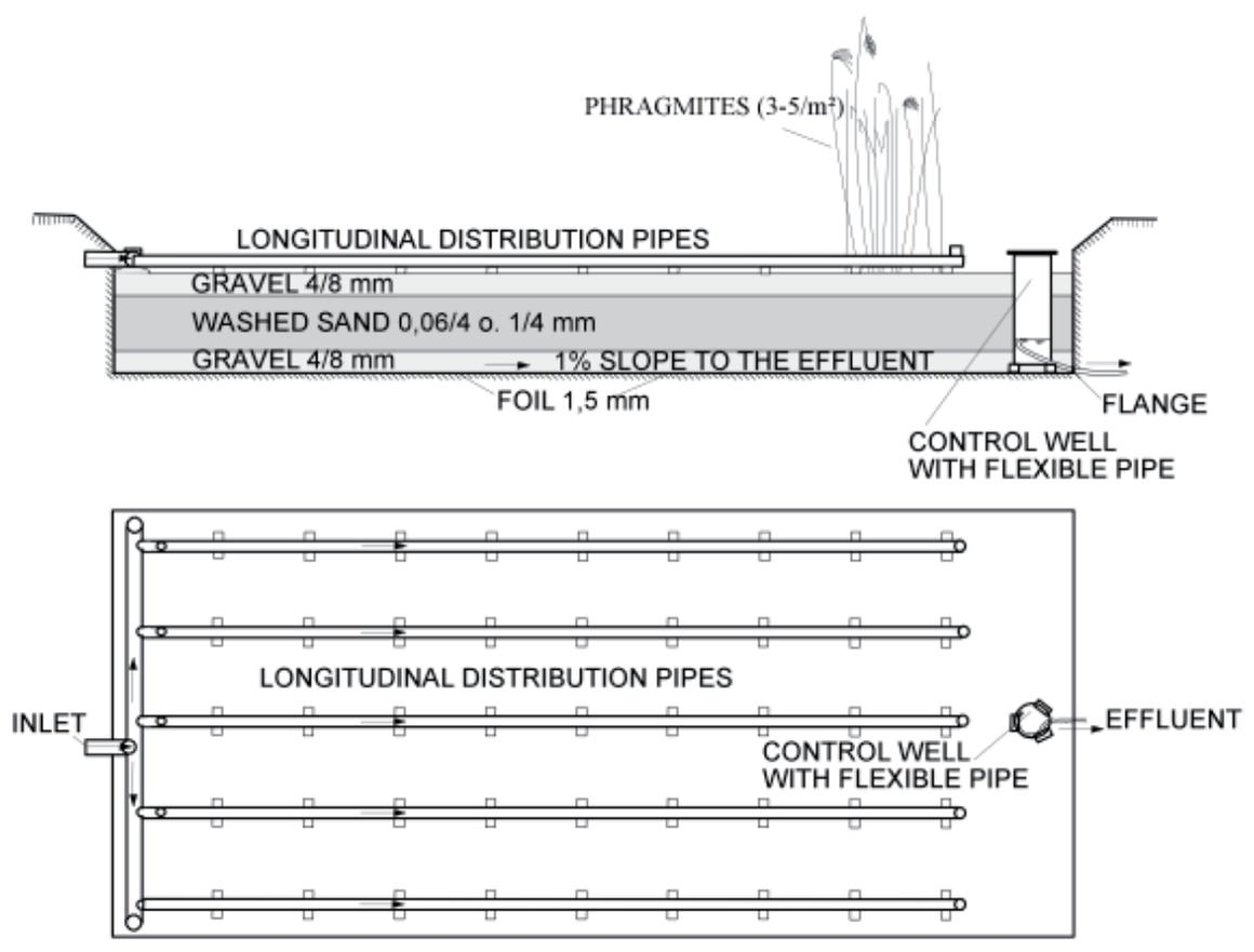
Figure 2. Sketch of the VF filter of the CW system „Type Ökologisches Projekt“
