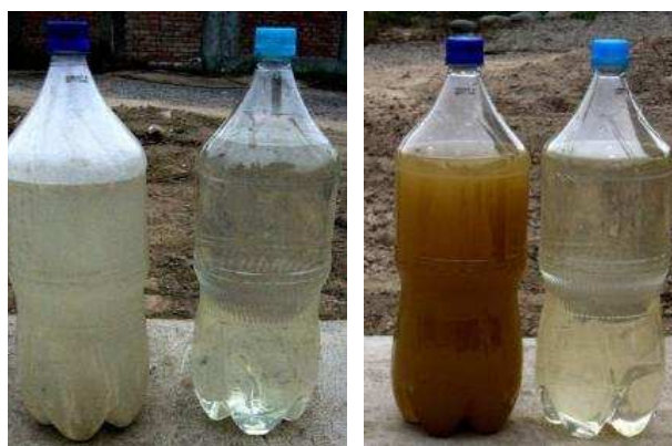
Figura 4. Izquierda: Agua gris pretratada y efluente después del HFV, para ser reutilizado en el riego de cultivos, Derecha: Agua negra pretratada y efluente después del HFV, para ser reutilizado en el riego de áreas verdes, la coloración marrón es típica en aguas residuales y es causada por los ácidos húmicos y huminas (fotos H. Hoffmann, 2008).
