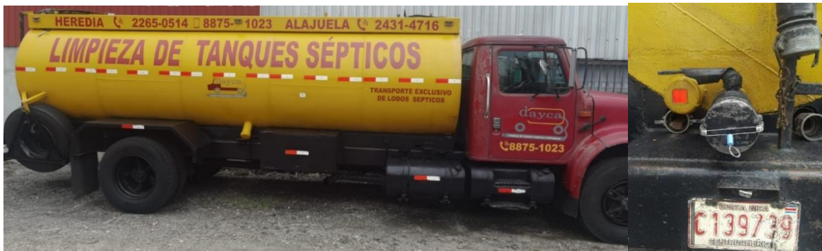
Figura 7: Camión succionador (izquierda). Marchamo de seguridad utilizado por las PTAR y exigido por el MINSa para evitar descargas ilegales (derecha).
