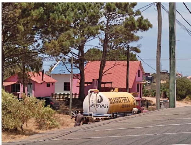
Figura 5: Camión equipado con una manguera de succión de la empresa El Indio usado para realizar la tarea de vaciado de tanques sépticos. Fuente: (D&A y EP, 2021).
