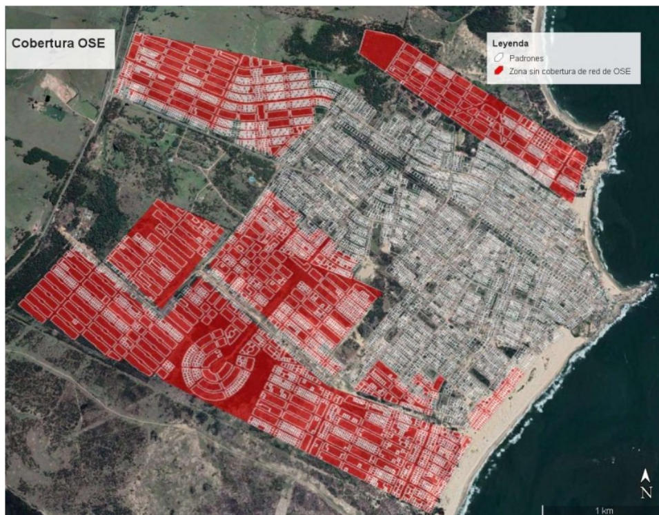
Figura 9: Croquis de la red de distribución de agua potable de OSE. En rojo, las zonas no cubiertas por la red de distribución. Fuente: (D&A y EP, 2021).
